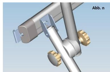
Nun kann der Schienenträger (3) eingesetzt und mit den Sechskantschrauben M6x60 mm (5) handfest (ca. 2-3 Nm), so dass sich der Schienenträger noch leicht hochklappen lässt, angezogen werden. Danach werden die Befestigungskralle (11) am Bügel für Haltekrallen (15) montiert.
