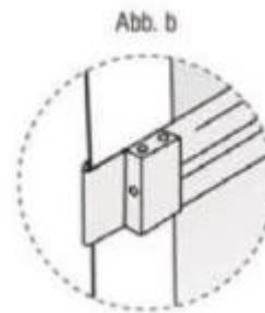
Prüfen Sie bitte nach der Montage alle (auch die vormontierten) Schraubverbindungen nochmals auf Ihre Festigkeit! Wiederholen Sie diese Prozedur nach spätestens 50km Fahrstrecke nochmal!
